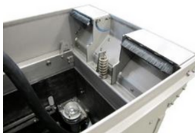
Otwory do wyprowadzenia kabli w stanie zamknięcia.
