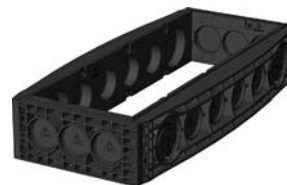
Rama 220 mm Nr produktu: BP-102384 3 x Ø 110 6 x Ø 110 / 2 x Ø 160 Waga: 23,0 kg
